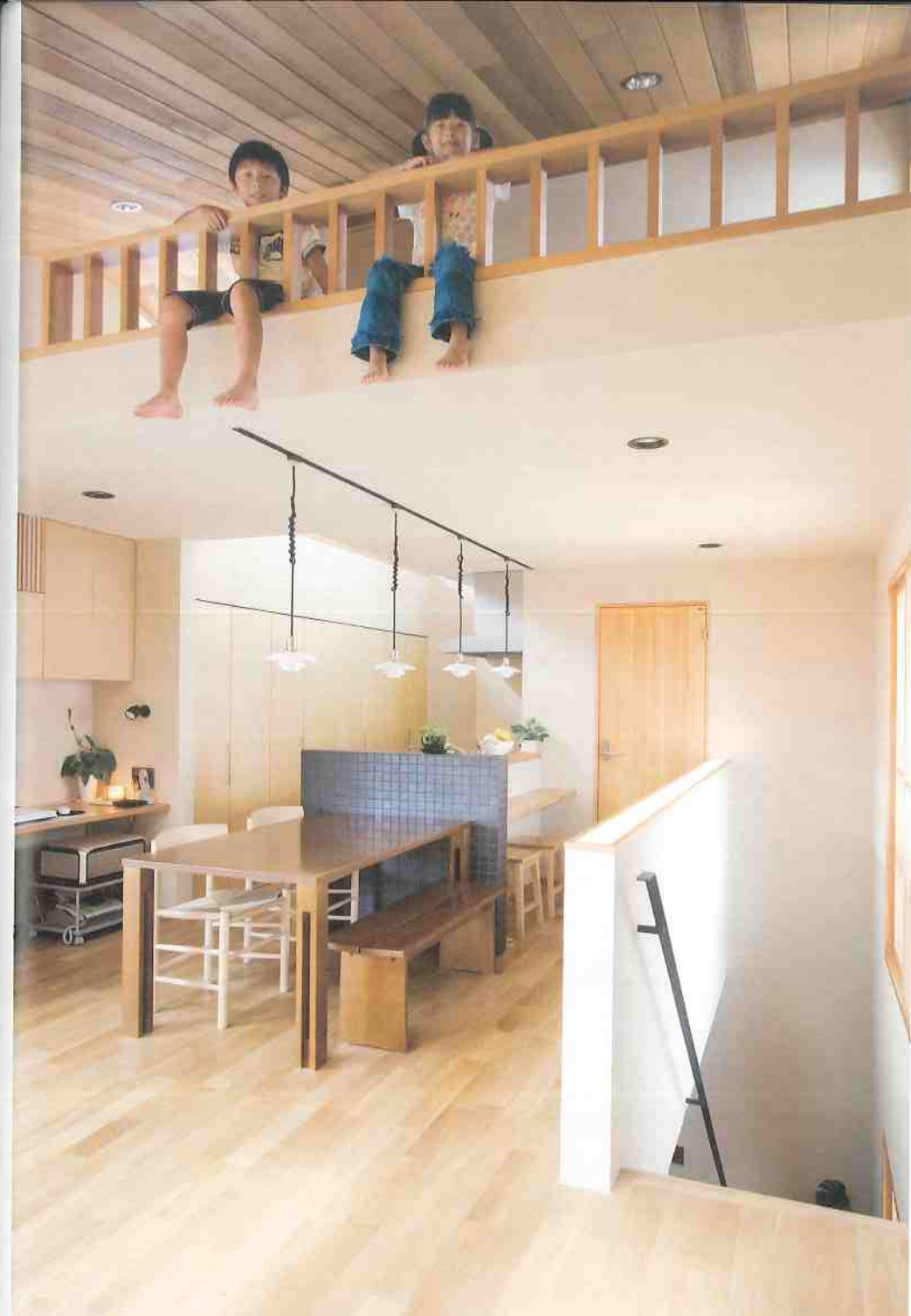
両隣に建物がある土地でも採光が確保できるよう、2階リビングを希望されたKさん。すると同社は、「それなら勾配天井にしては」と開放感溢れる設計を提案。その結果、高い天井を活かしたロフトが生まれ、天井にはレッドシダーを張り、木質感いっぱいに仕上げた
